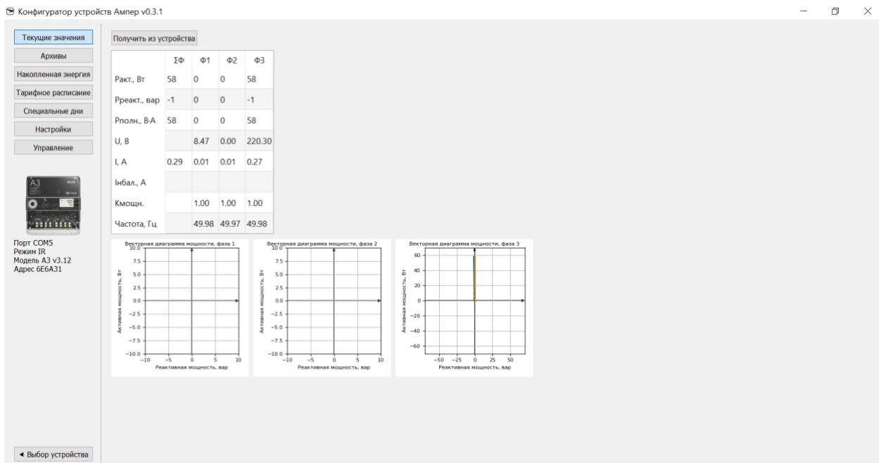
Рисунок 4 Экран отображения текущих значений, полученных из устройства А3
