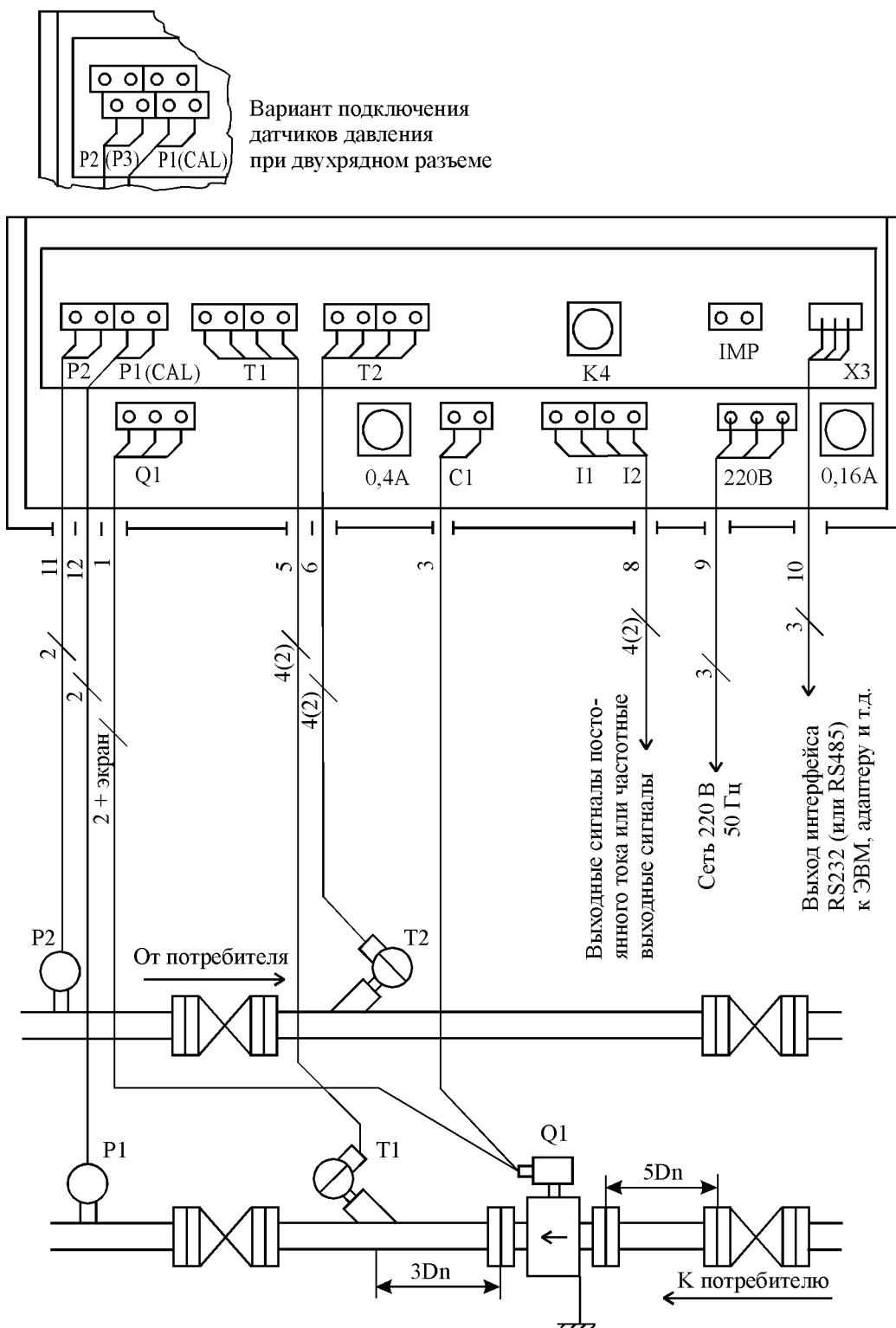
**Рисунок 12 – Пример установки теплосчетчика на прямом трубопроводе**
