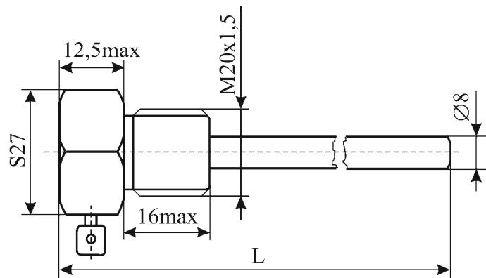
**Рисунок 6 – Габаритные, установочные и присоединительные размеры термопреобразователя и защитной гильзы**
