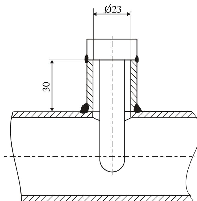
**Рисунок 14** - Установка защитной гильзы
