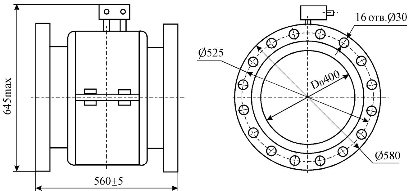
Присоединительные размеры фланцев по ГОСТ 12815-80 исполнение 1 на условное давление Ру 1,6 МПа (16 кгс/см<sup>2</sup>), конструкция фланцев по ГОСТ 12820-80.
