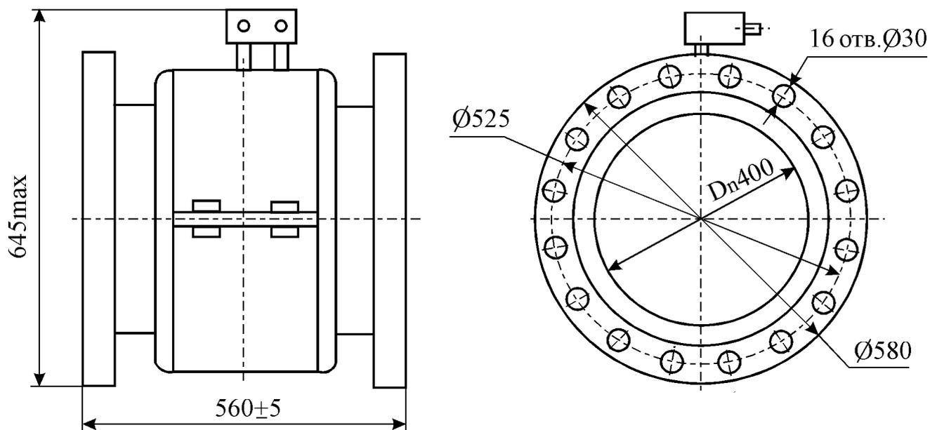
Присоединительные размеры фланцев по ГОСТ 12815-80 исполнение 1 на условное давление  $P_u$  1,6 МПа (16 кгс/см<sup>2</sup>), конструкция фланцев по ГОСТ 12820-80.
