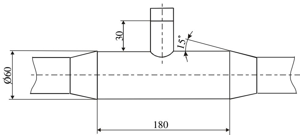
**Рисунок 13** - Установка защитной гильзы
