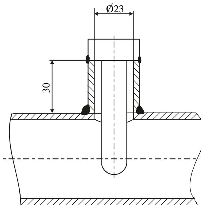
**Рисунок 14** - Установка защитной гильзы на трубопроводе при  $D_n = 50$  мм
