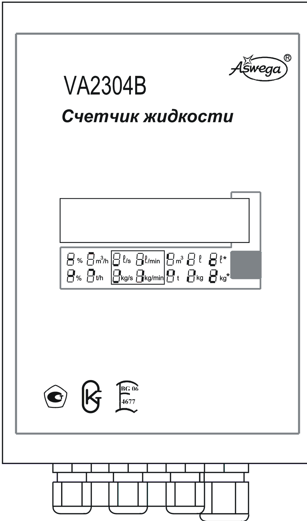
Рисунок 8 – Вид спереди вычислительного блока настенного исполнения
